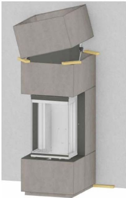
Das obere Hauben-Element (mit der größeren Ausschnitt-Vorbereitung) auflegen. Hierbei ggf. das untere Hauben-Element mit Holzleisten schützen. Auch hier wieder darauf achten, dass die mit Nuten ausgestatteten Elemente passgenau übereinanderstehen.
