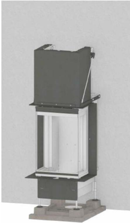
**Der Einsatz muss so ausgerichtet und eingestellt werden, dass der Abstand zwischen Herdbodenplatte und der Aufstellfläche der Beton-Sockelverkleidung (auf der Bodenplatte; s. Skizze) 35 cm beträgt. Das ist die Höhe des ersten Beton-Verkleidungs-Elementes.**
