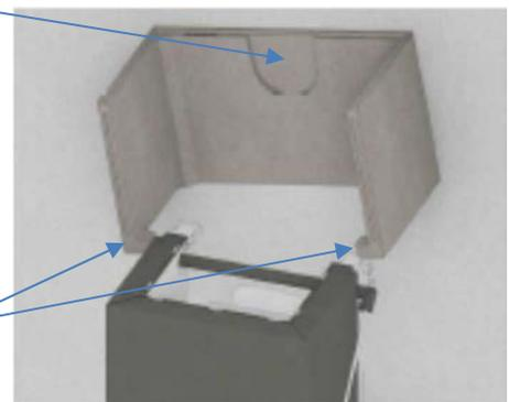
Für die Montage der vorderen Hälfte der Sockelverkleidung werden zuerst zwei 4 cm hohe Hölzer vor den Ofen gelegt. Hierauf kann dann dieses Sockelelement abgelegt und dann vorsichtig auf die Sockelplatte geschoben werden.
